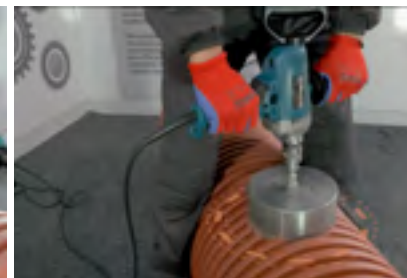
4. Bušenje rupe krunastom testerom
